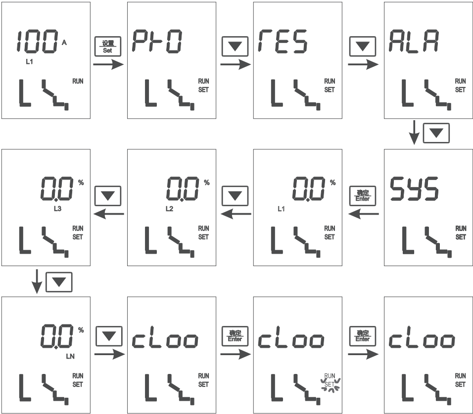
图63 零点校准
