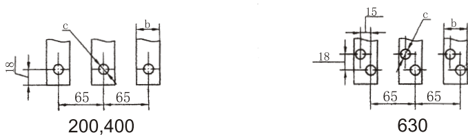
图6 各结构段母线尺寸
