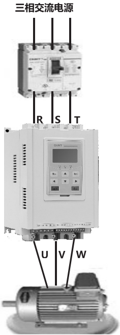
图 2 基本接线示意图
