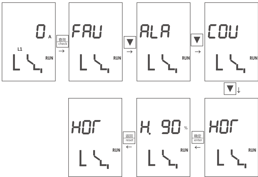
图9.11 故障脱扣后查询热容信息
