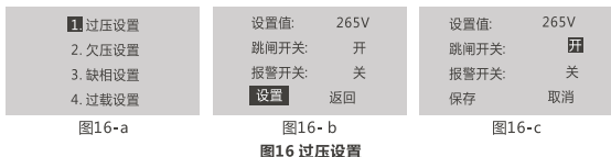
图16- b 图16 过压设置
