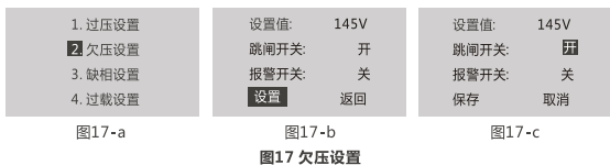
图17- b 图17 欠压设置
