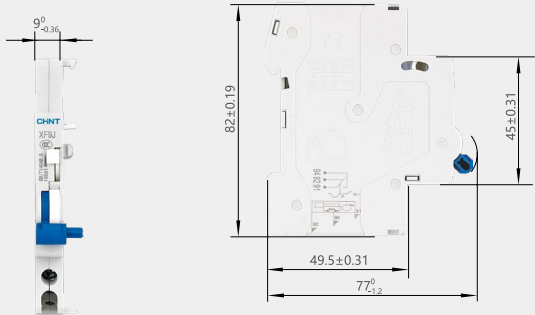
图3 外形及安装尺寸
