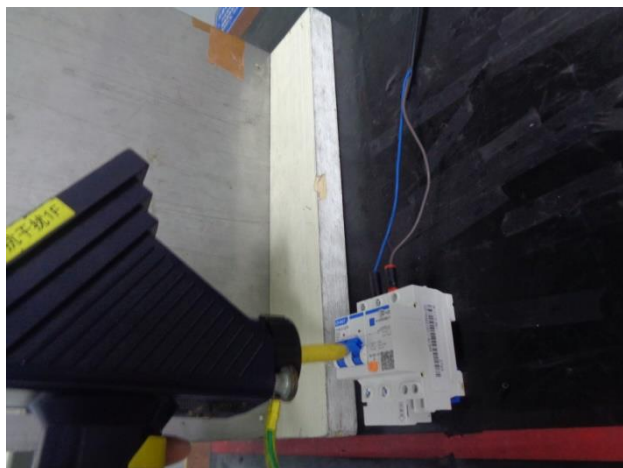
静电放电试验布置图
