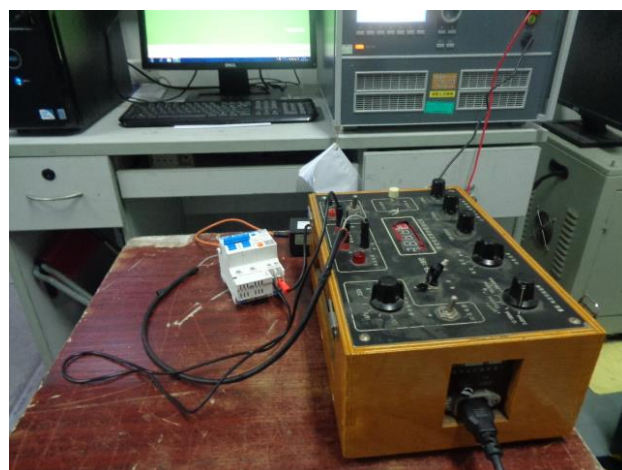
低于 150kHz 频率范围内的共模传导骚扰试验布置图
