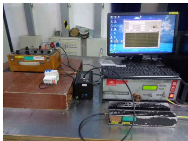
传导正弦波电压或电流试验布置图
