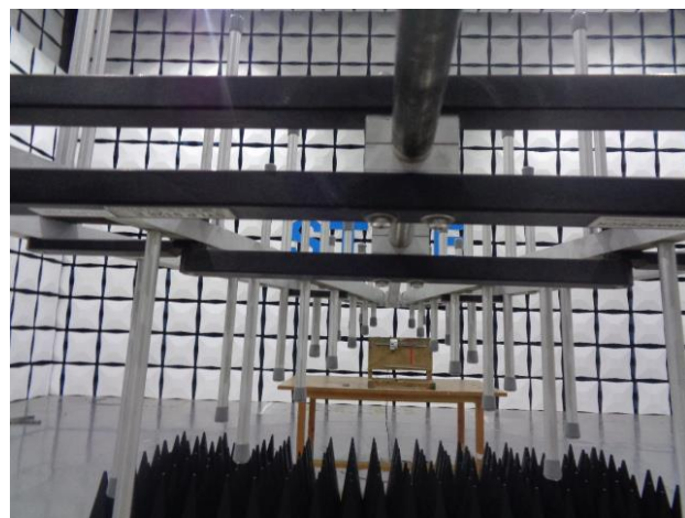
射频电磁场辐射试验 (80~1000MHz 垂直) 布置图
