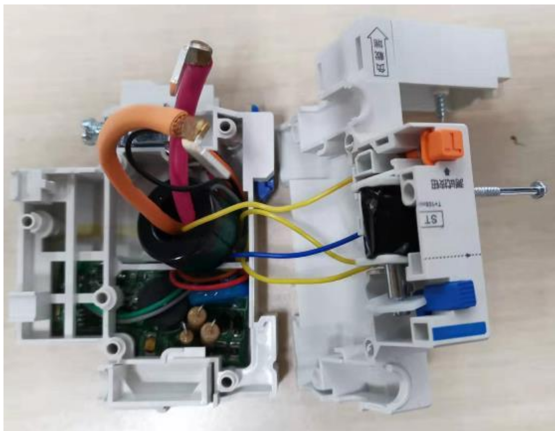
漏电模块内部结构图
