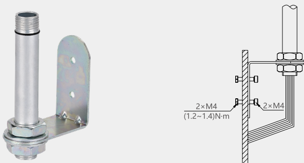
图8 NDT1-52侧向式安装示意图
