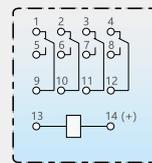
底视接线图(2Z带指示灯)
