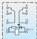
底视接线图(3ZS带指示灯)
