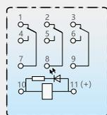
底视接线图(4ZS带指示灯)
