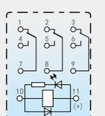
底视接线图(4ZS带指示灯及二极管)
