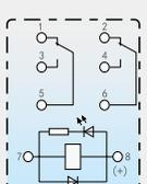
底视接线图(2ZS带指示灯及二极管)
