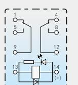
底视接线图(3ZS带指示灯及二极管)
