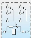
底视接线图(2ZS带指示灯)
