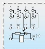
底视接线图(2Z带指示灯及二极管)
