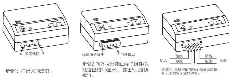
图6 接线安装步骤
