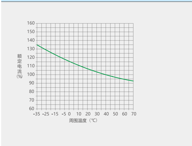
图 38 NM1-1250 温度补偿曲线
