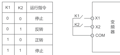
图 8-1-1 两线制控制模式 1
