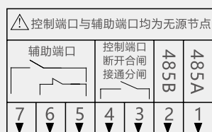
图12二次端子接线图(N相左置产品)
