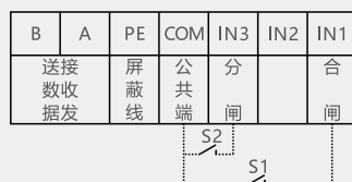
图11 二次端子接线图(N相右置产品)
