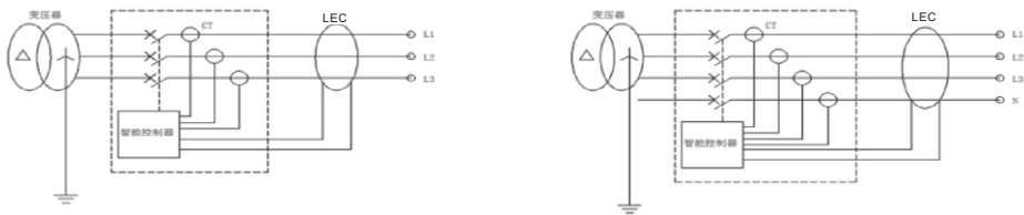
图6 LEC漏电保护检测原理
