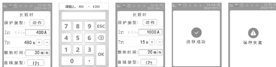
图29 过载长延时保护设定
