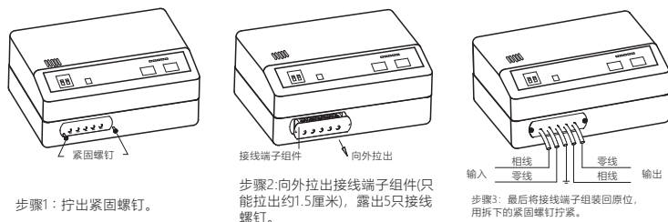
图6 接线安装步骤
