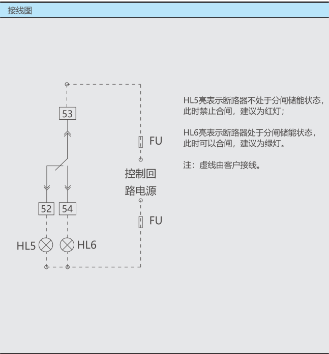
SPC 合闸准备就绪触点接线图
