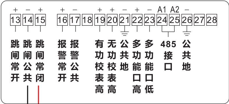
国网2013版三相智能电能表（无源）接线端子示意图
