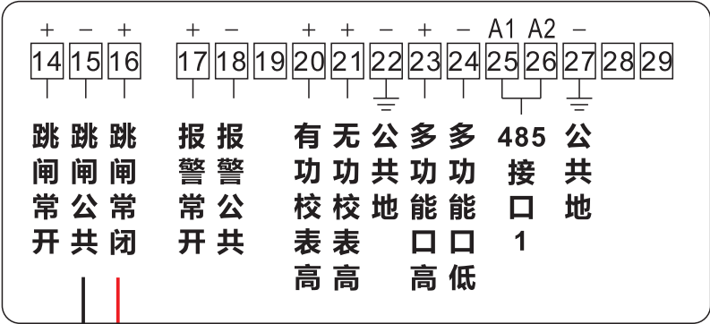
国网2020版三相智能电能表（无源）接线端子示意图
