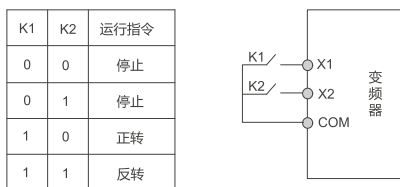
图 8-1-2 两线制控制模式 2
