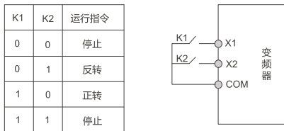
图 8-1-1 两线制控制模式 1
