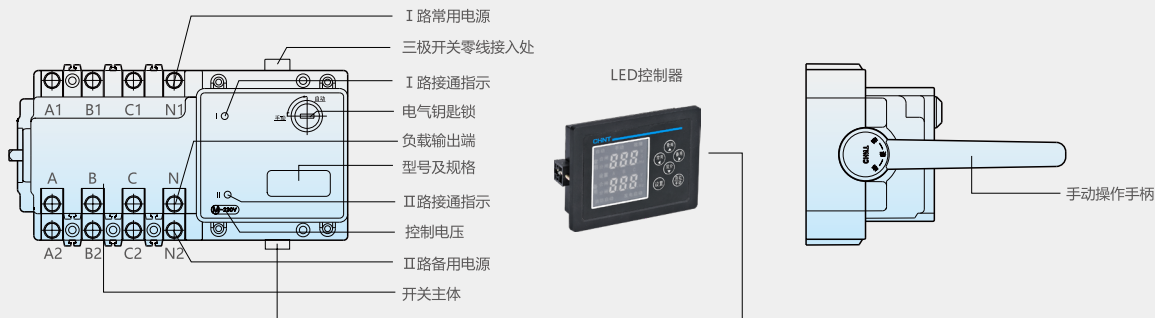
NH42-16~630/SZ Ⅰ、Ⅱ、Ⅲ型接线方式（三极开关的 N 极未安装接线端子与触头）
