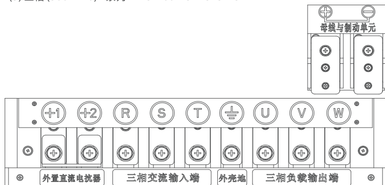
图4.11 主回路端子 NVF3-160T-S4~315P-S4
