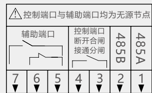
图12二次端子接线图(N相左置产品)
