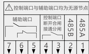
图12二次端子接线图(N相左置产品)
