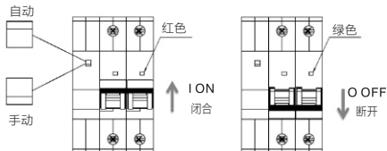
图2 产品手动、自动状态，闭合、断开状态指示
