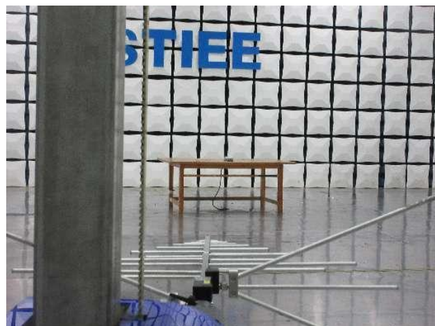
辐射式发射 (30-1000MHz 水平) 试验布置图
