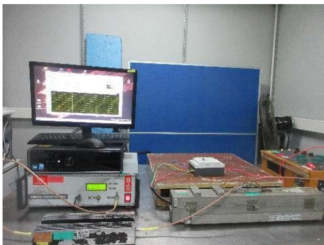
传导式发射试验布置图
