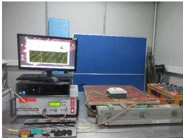
射频场感应的传导骚扰试验布置图
