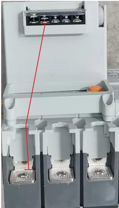
不同电压的电路导体之间电气间隙和爬电距离
