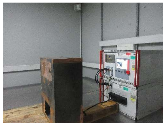
电快速瞬变脉冲群试验布置图
