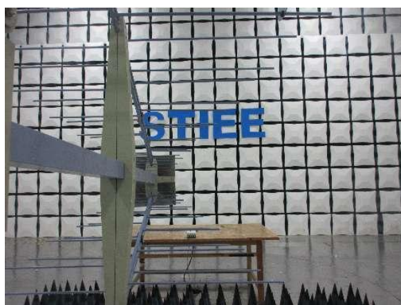
射频电磁场辐射 (80-1000MHz 水平) 试验布置图
