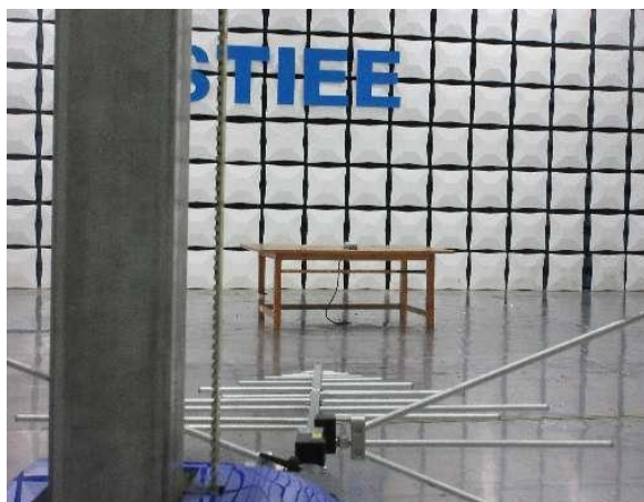
辐射式发射 (30-1000MHz 垂直) 试验布置图
