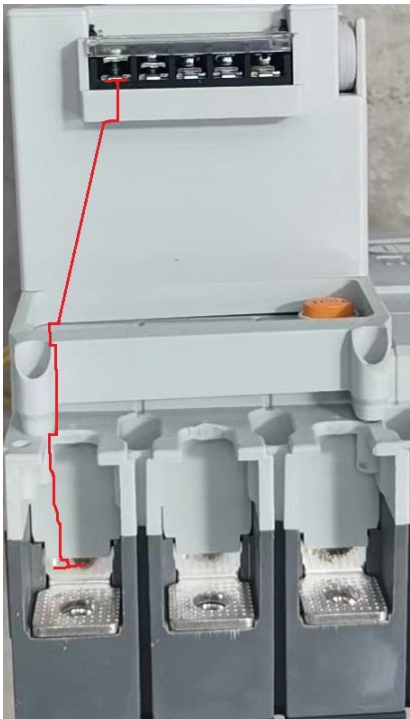
不同电压的电路导体之间电气间隙和爬电距离
