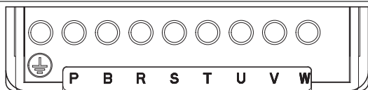
图5-7 主回路端子NVF5-0.4GS-7.5GS
