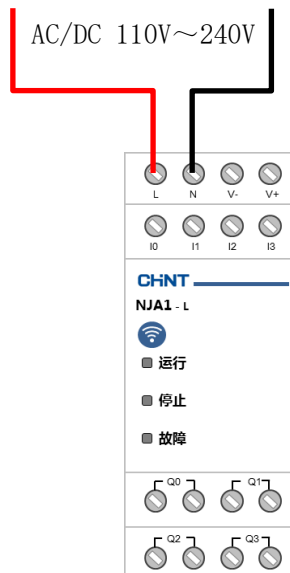
图 2.5.1 供电电源接线图
