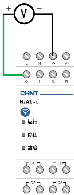
图 2.5.3 模拟量输入接线图
