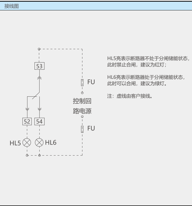
SPC 合闸准备就绪触点接线图
