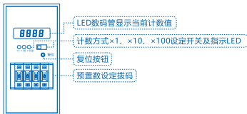
图5 JDM1-14面板示意图
