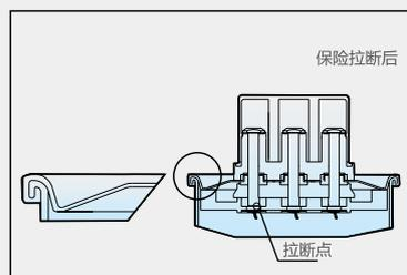
安全保护原理: 因内部压力增大, 上盖凸起而拉断柔性保险。
