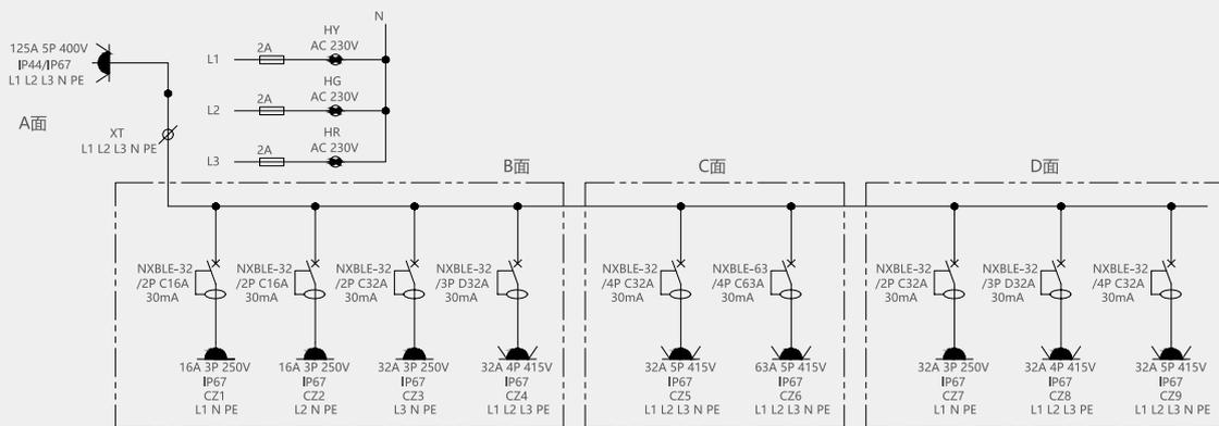
2 个小型漏电断路器 NXBLE-32/2P C16A 30mA
