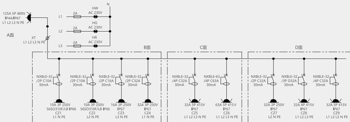
2 个小型漏电断路器 NXBLE-32/2P C10A 30mA
