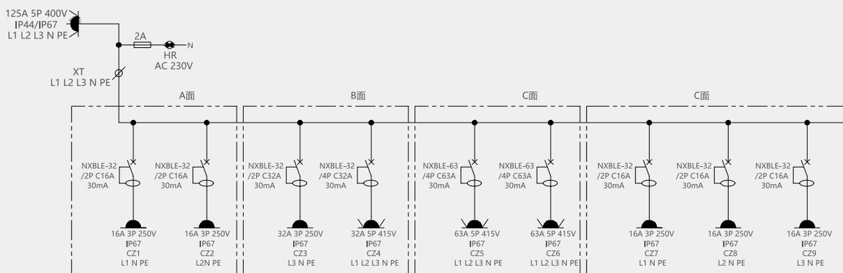
5 个小型漏电断路器 NXBLE-32/2P C16A 30mA
