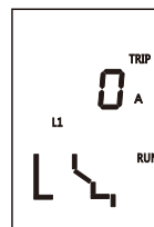
图61 按“Test”键进行模拟瞬时脱扣状态
