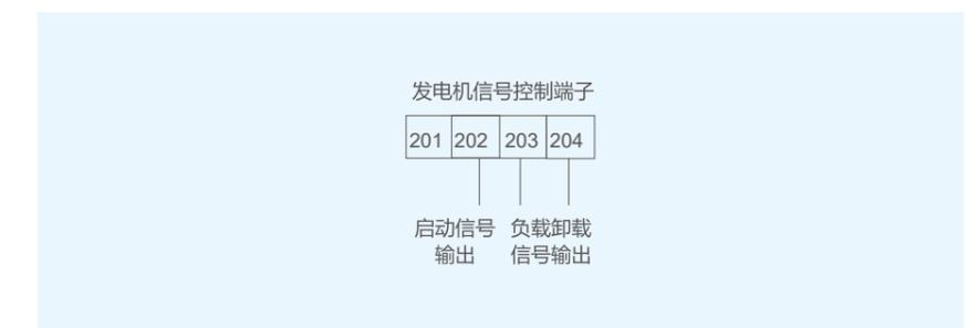
**注** 201、202 为一组常闭端子，当常用电源正常，此端子处于断开位置，当常用电源故障，经过控制器程序中设置的延时时间后，端子处于闭合状态，输出发电机启动请求信号。当常用电源主电路断开后，203、204 端子内部干接点输出闭合的无源信号，进行负载卸载。
