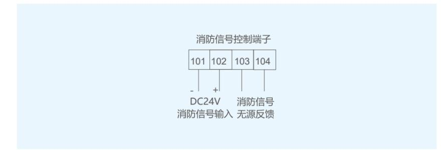
**注** 101、102 接到消防联动信号，产品位置强制切换为分闸位置后，103、104 端子内部干接点输出闭合的无源信号。此功能只适用三段式产品。
