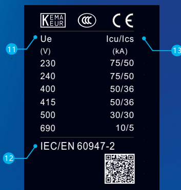
NXMH热磁固定式塑壳断路器铭牌
