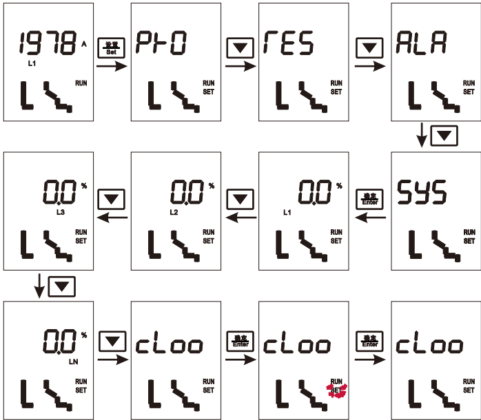
图64 零点校准操作
