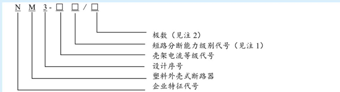
注：1. 短路分断能力级别代号：C(普通型)、S(标准型)、Q(高级型)；
