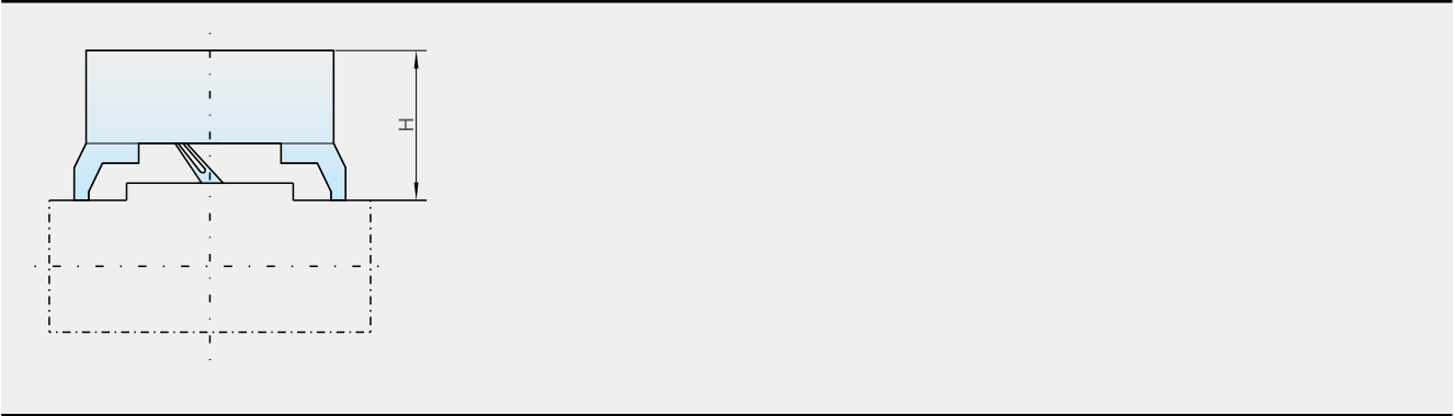
电动操作机构安装尺寸图
