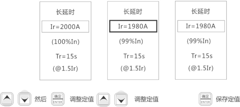
图22 过载长延时保护设定
