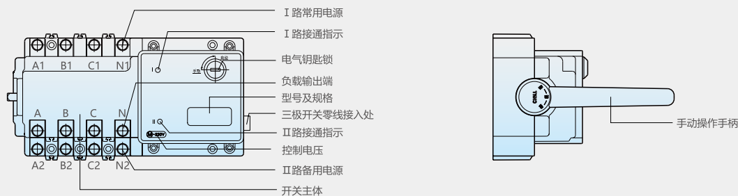
NH42-16~630/SZ 普通型接线方式（三极开关的 N 极未安装接线端子与触头）
