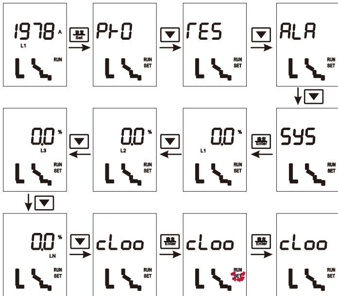
图65 零点校准操作
