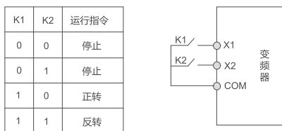
图 8-1-2 两线制控制模式 2
